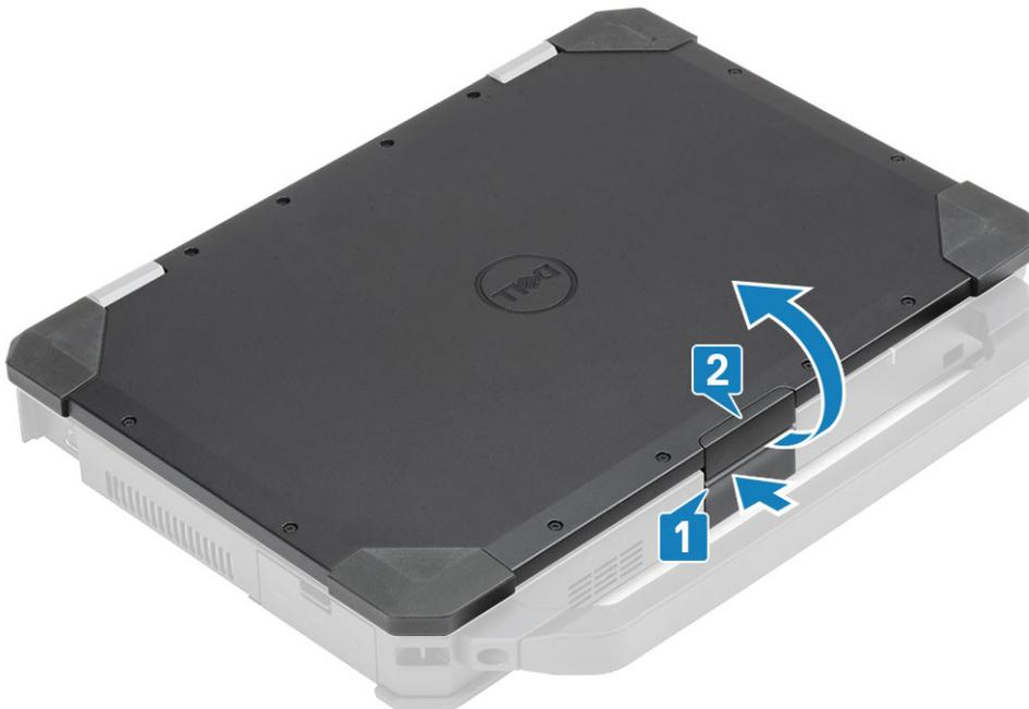
5. Segure a tampa do LCD em um ângulo obtuso e empurre as tampas da dobradiça da extremidade traseira para removê-la do computador.
