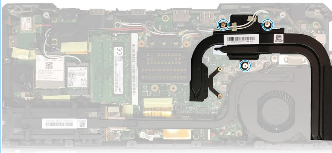
dissipador de calor DSC
