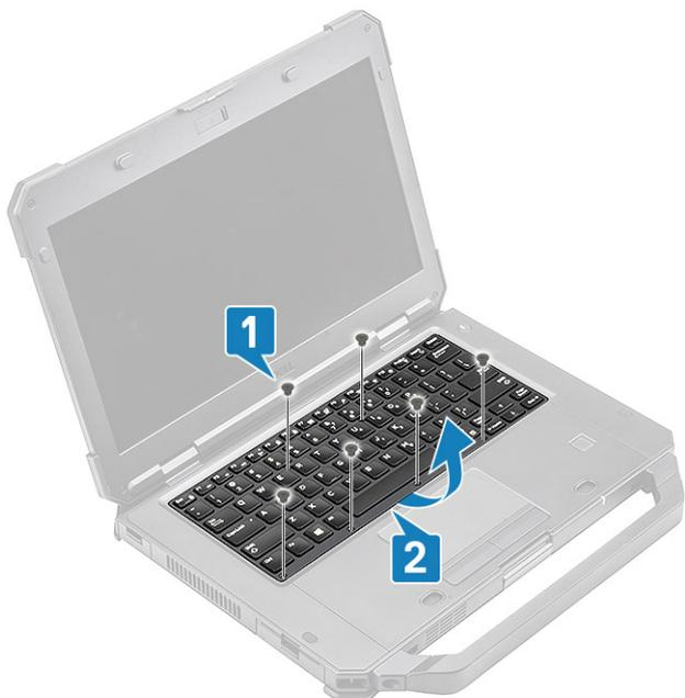
4. Deslize ligeiramente o teclado [1] na direção do touch pad e vire-o inclinado sobre o painel LCD [2].
