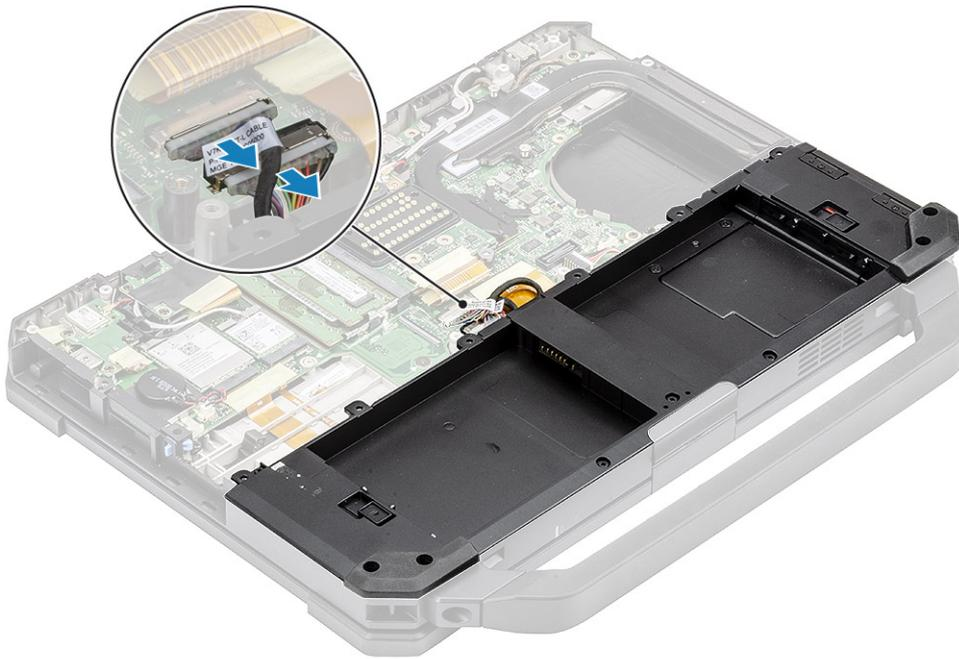
4. Remova os cinco parafusos 'M2.5\*5' [1] e os nove parafusos 'M2.5\*3' [2] que prendem o compartimento da bateria ao chassi e levante para separar o compartimento da bateria [3] do computador.
