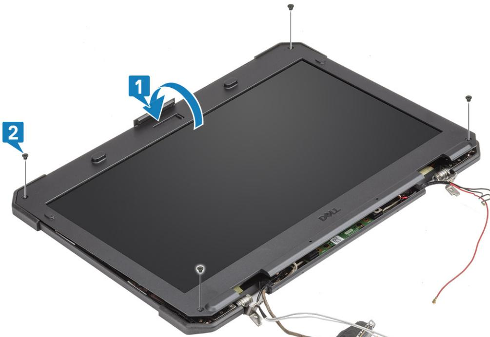
5. Instale os 12 parafusos 'M2.5' para prender a tampa traseira no LCD com o conjunto do painel.
