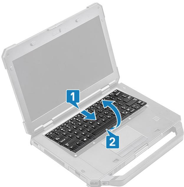
5. Remova os quatro parafusos 'M2\*3' [1] sobre a tampa do teclado e remova-a do computador [2].
