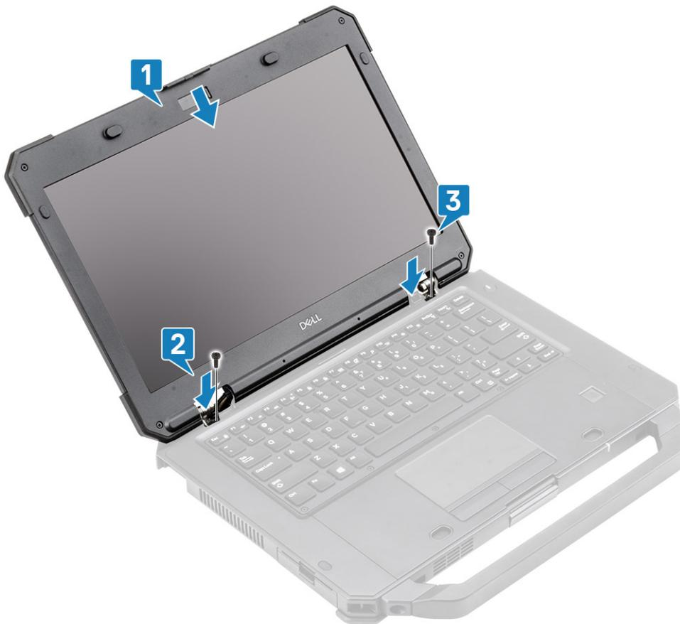
2. Instale os dois parafusos epoxídicos 'M2\*3' que prendem as dobradiças ao conjunto da base [1] e rosqueie novamente os cabos das antenas [2].
