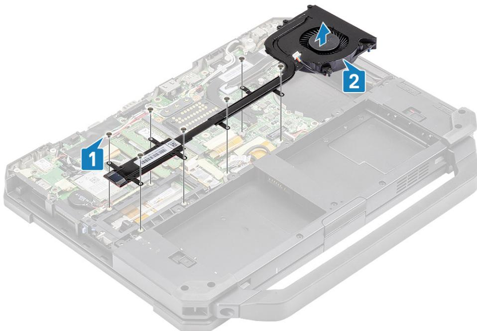
5. Remova os quatro parafusos M2\*3 [1] para separar o dissipador de calor do ventilador [2].
