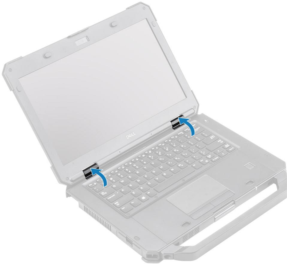
3. Coloque os suportes [1] e prenda-o usando dois parafusos 'M2,5\*5' em ambos os lados [2].
