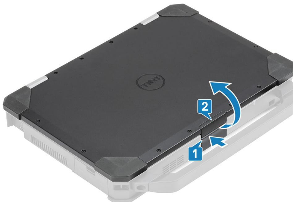
1. Pressione a trava do LCD localizado no chassi inferior.
